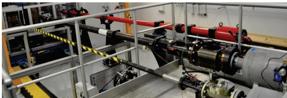
Figure A1-2 : Lanceur à gaz utilisé (au centre)
