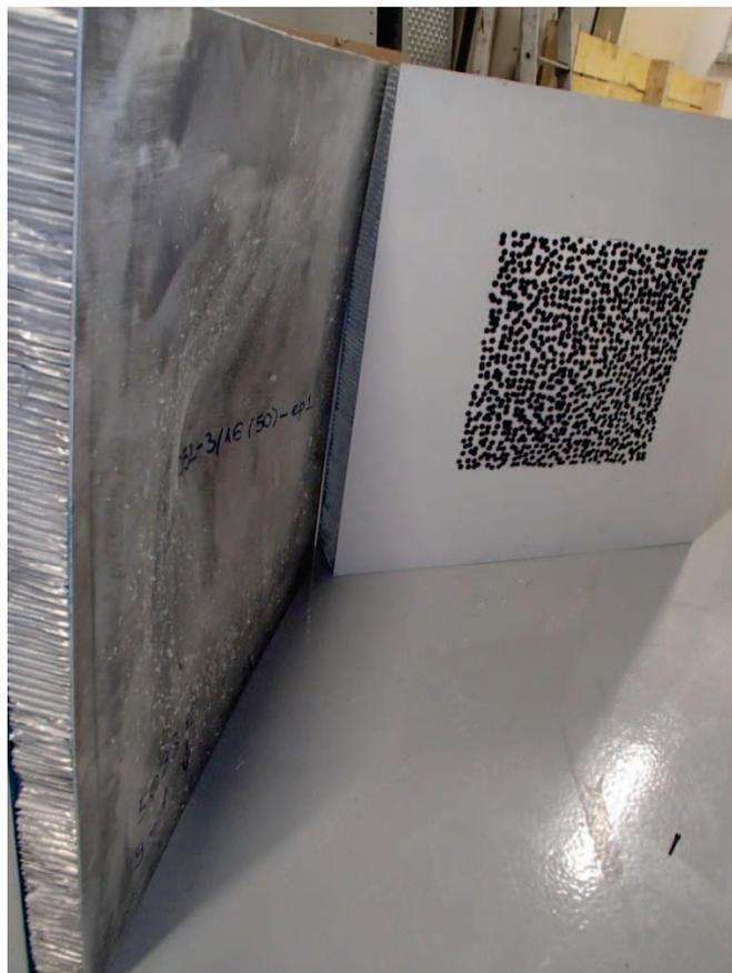
Figure A1-5 : Face avant de l'éprouvette 3 et face arrière de l'éprouvette 5, après impact
