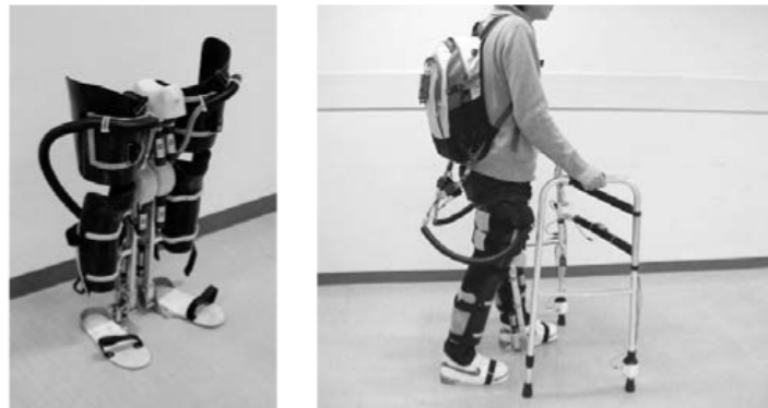
Figure 6.8 – Exosquelette WPAL (gauche) et exemple de marche avec l'exosquelette ainsi qu'un déambulateur (droite) Source : KAGAWA et UNO, 2009
